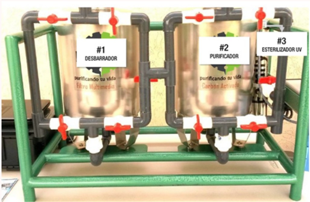
Miniplanta de Tratamiento de Agua Potable
